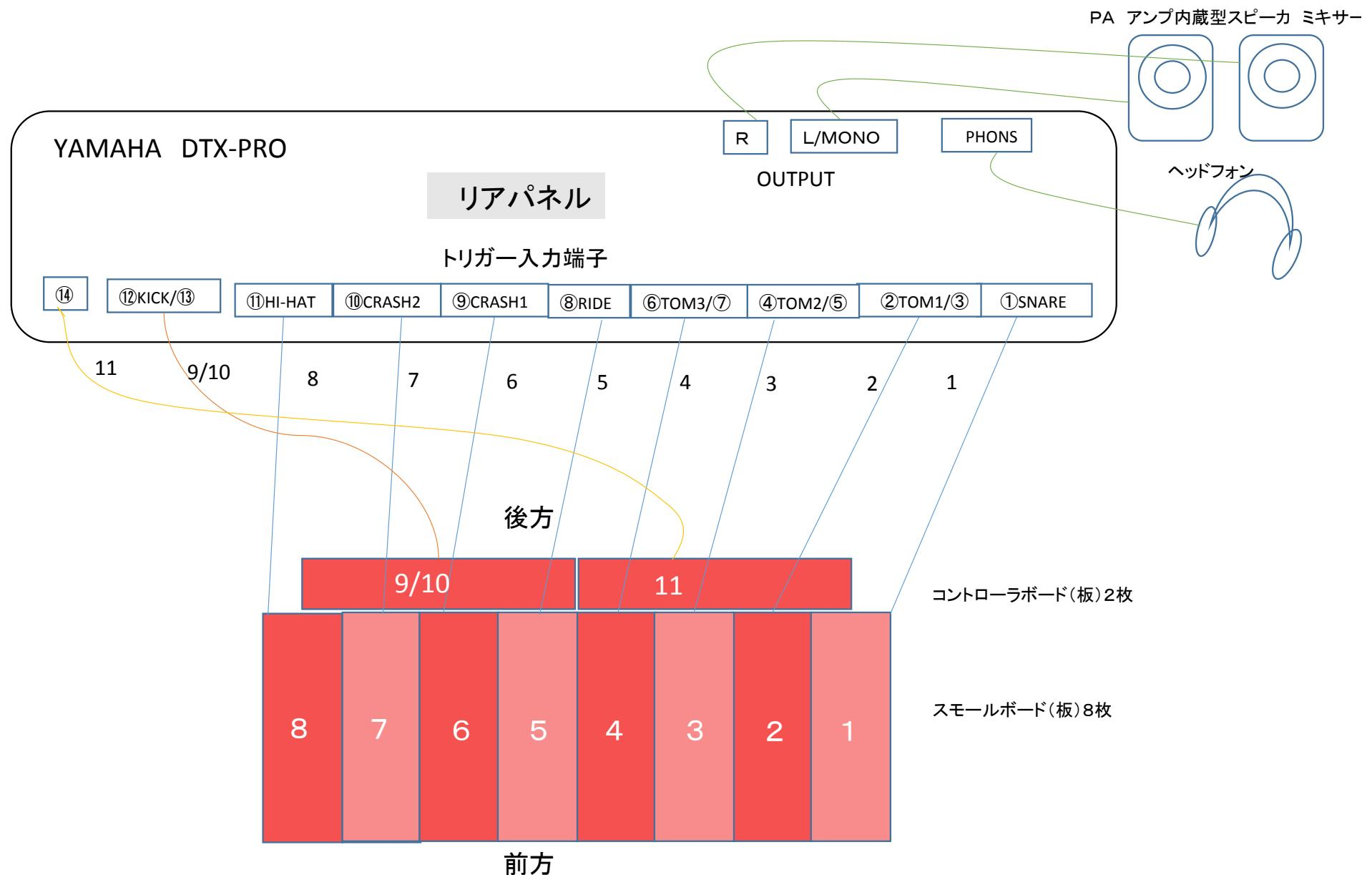
接続方法：ボードのピックアップ出力端子(コネクタ)と音源(DTX-PRO)のトリガー入力端子の接続はラインケーブル(標準モノラルフォーン)を使います。
